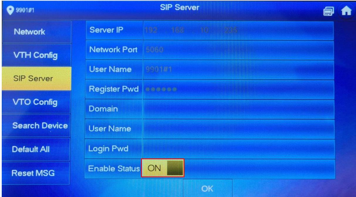
Den Enable Status des Main VTO auf ON setzen.
