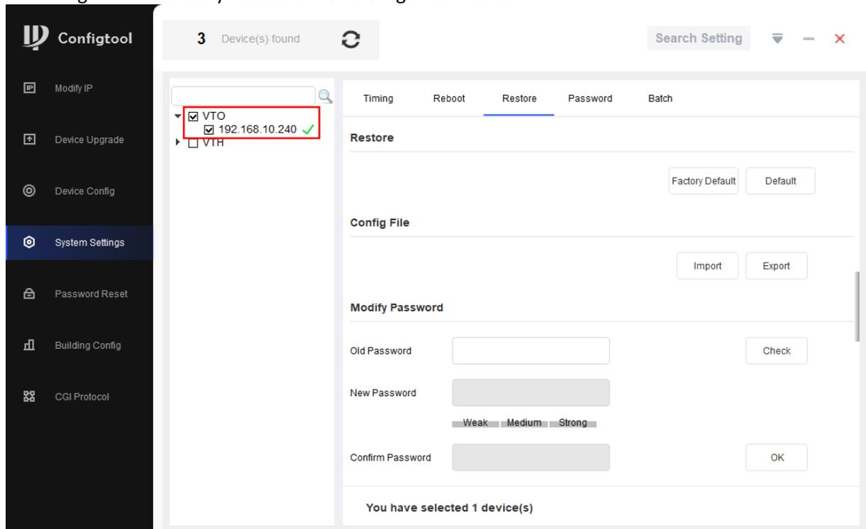
Bei Passwort Error unter «Search Setting» das richtige Passwort eingegeben und anschliessend der komplette Schritt wiederholt werden.
